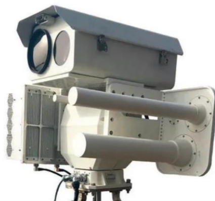
1.3-сурет – Дронды анықтаудың оптикалық жүйесі
