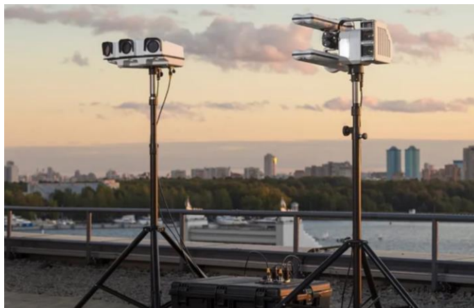
1.2-сурет – Ұшатын ұшқышсыз ұшу аппараттарын акустикалық жолмен анықтау
